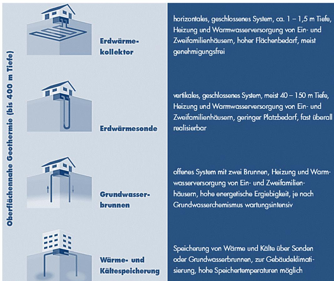
Abbildung 3-7: Nutzungsmöglichkeiten oberflächennaher Geothermie<sup>21</sup>
