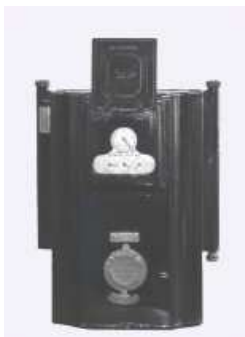
Von Beginn an sorgen Gaszähler für die Abrechnung der Kunden mit der Gas-Anstalt
