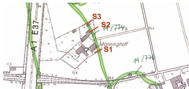
Abbildung 2. Abbildung der durchgeführten Schürfe zur Bodenbeurteilung
